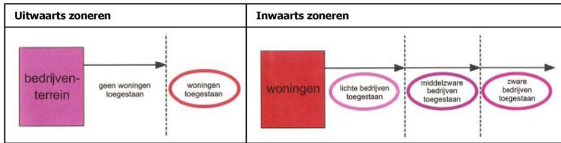
Figuur 4: principe van inwaarts en uitwaarts zoneren [Bedrijven en milieuzonering, 2007]
